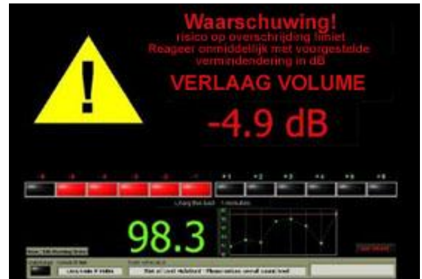
De melding “VERLAAG VOLUME” komt erg snel op het scherm; aanpassingen in het niveau zullen dus bijna onmiddellijk effect hebben
